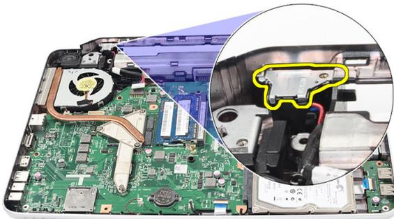
6. Levante a porta da entrada de alimentação do computador e retire-a.
