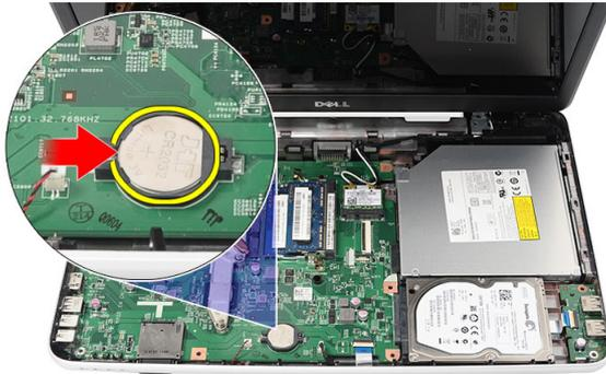
4. Retire a pilha tipo moeda do computador.
