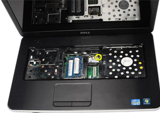
5. Retire a placa WLAN do computador.
