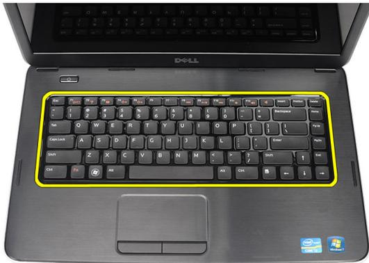
5. Desligue o cabo do teclado da placa de sistema.
