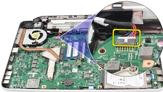
4. Retire o parafuso que fixa a porta e o suporte da entrada de alimentação.
