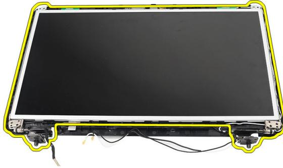
8. Retire os parafusos existentes nos suportes esquerdo e direito do ecrã. Retire o painel do ecrã.
