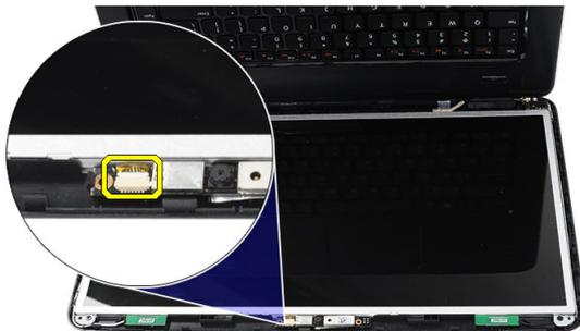
5. Abra o trinco, levante a câmara e retire-a do computador.
