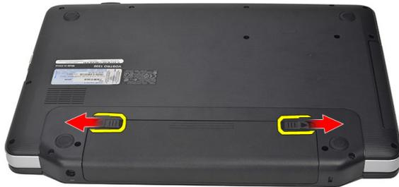
3. Faça deslizar a bateria e retire-a do computador.
