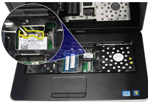
4. Levante o trinco para soltar a placa WLAN do respectivo compartimento.
